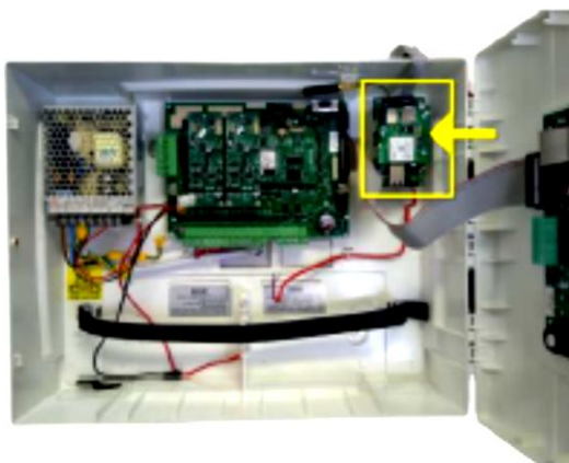
שרטוט 4 מודול MCOM-7 (מימין) ו-MCOM-7 בתוך ארון הרכזה (משמאל)
